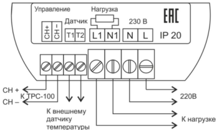
В терморегуляторе установлены клеммные колодки типа «Микролифт». Макс. сечение проводов 2,5 мм<sup>2</sup>. Перед установкой провода выкрутить винт до упора против часовой стрелки, вставить провод в колодку и закрутить винт до упора по часовой стрелке.
